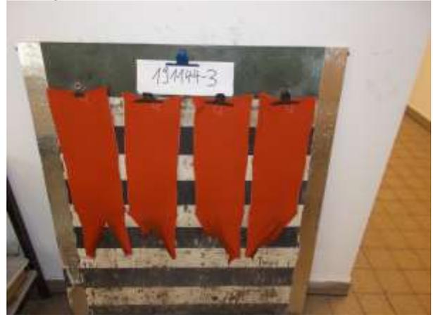
2.1.5 Brandschachtprüfung according to DIN 4102-1
