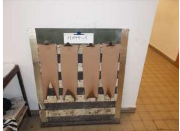
2.1.3 Brandschachtprüfung according to DIN 4102-1
